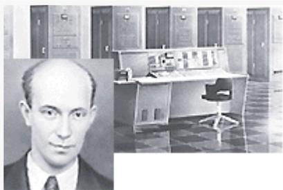
**Михаил Карцев построил ЭВМ М-4 была на принципиально новой элементной базе — полупроводниковых транзисторах**
